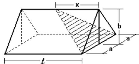
Chamando de  $x$  o comprimento do trecho a ser eliminado na cumeeira, ache os valores possíveis de  $x$  e discuta os valores de  $a$ ,  $b$  e do comprimento  $l$ , para que a reforma proposta possa ser executada.
