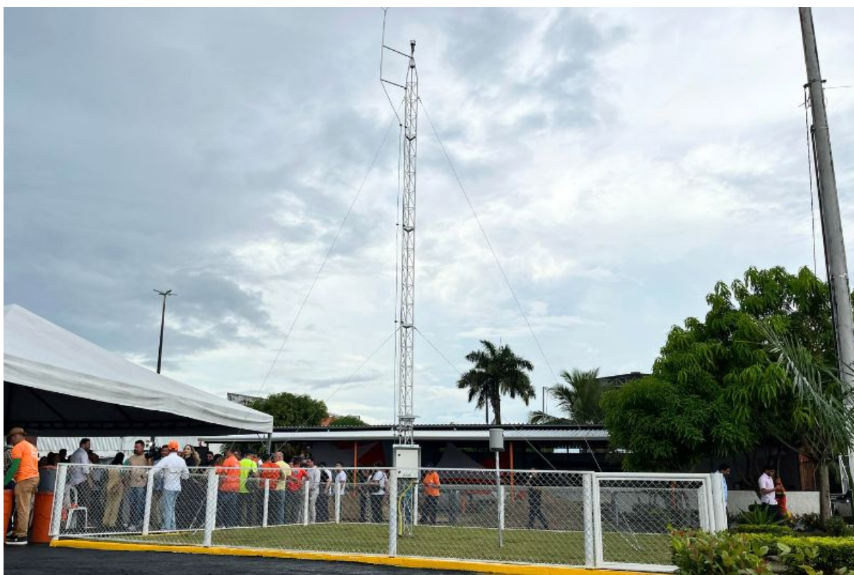
Figura 4.2: Exemplo de uma Estação Meteorológica Automática. Estes sensores em superfície são a principal fonte de dados locais de temperatura, umidade e vento.
