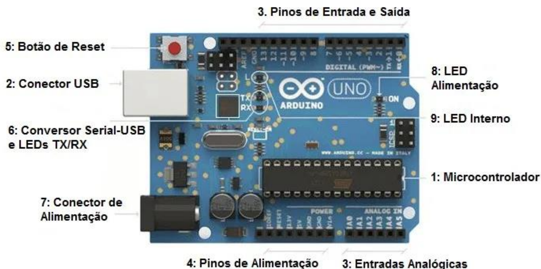
Figura 1 - Módulo do Arduino Uno
