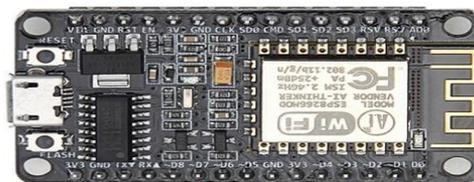
Figura 3: módulo ESP8266
